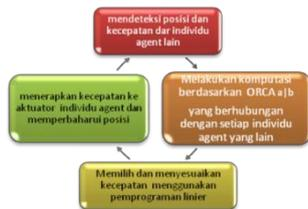
**Diagram 2.1** Diagram looping sensing pada algoritma ORCA
