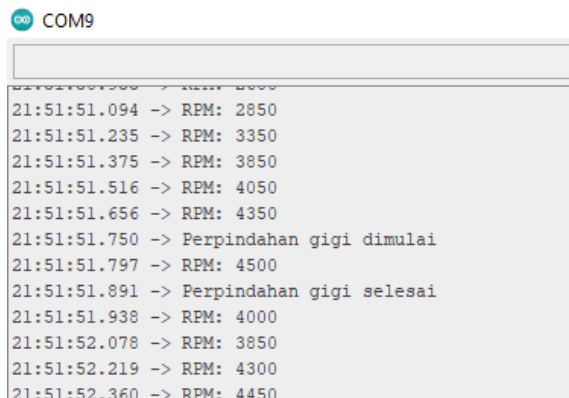
Gambar 7 Tampilan serial monitor pergantian gigi dengan quickshifter.
