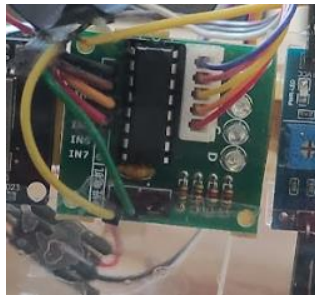
Gambar 22. Implementasi Modul ULN2003
