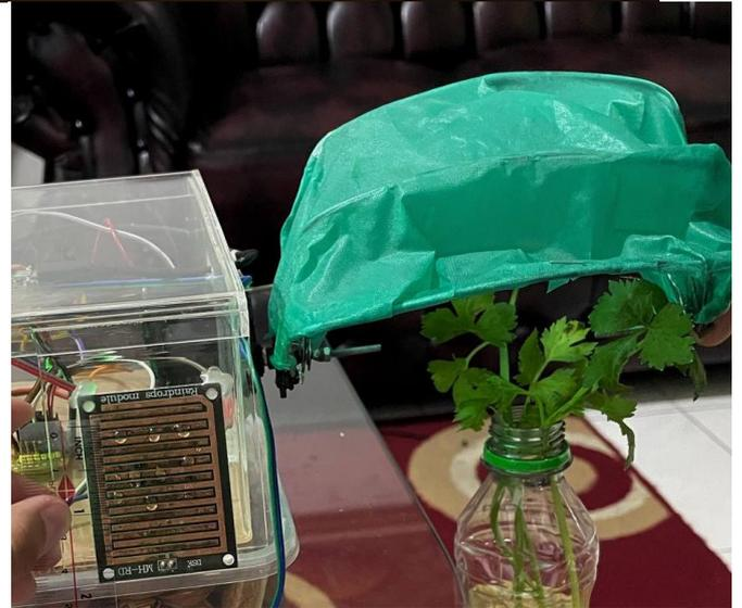
Gambar 18. Bidang Sensor Tertutup Air
