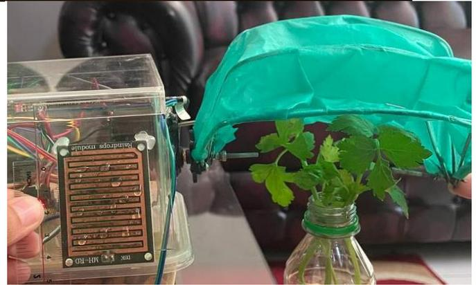
Gambar 13. Bidang Sensor Tertutup Air
