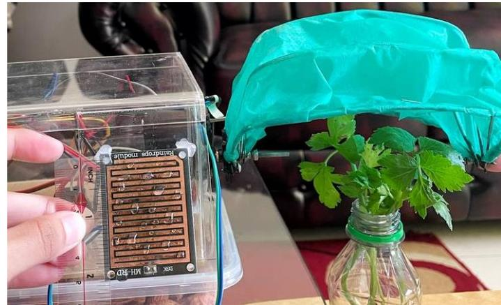
Gambar 8. Bidang Sensor Tertutup Air
