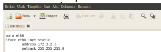
Gambar 21 Konfigurasi IP eth0 pada Cache Server
