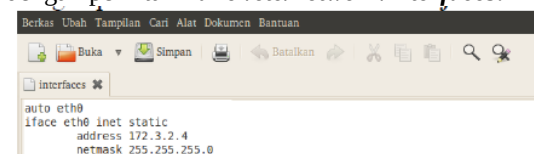
Gambar 22 Konfigurasi IP eth0 pada Client
