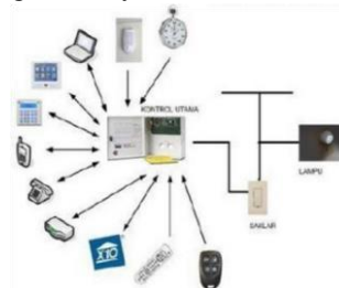
Gambar 2.2. Mengontrol Lampu melalui Kontrol Utama
