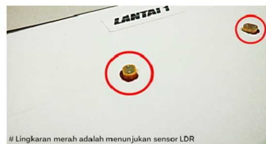
Gambar 5.2 Sensor LDR pada miniatur parkir mobil
