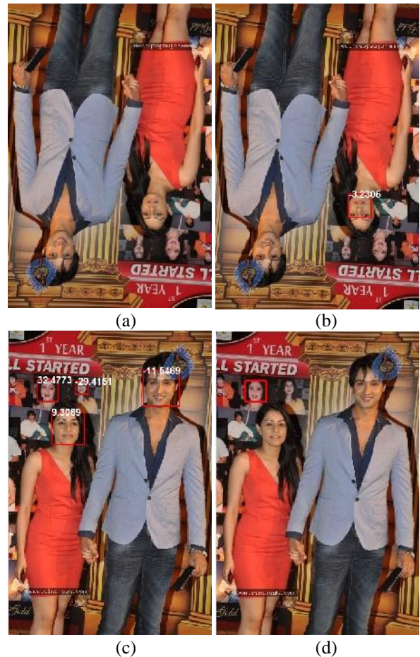
Gambar 9. Pencarian objek terbaik. Kotak merah adalah objek wajah yang terdeteksi dan Nilai F (warna putih diatas kotak merah). (a) citra masukan; (b) satu objek terdeteksi pada putaran 0^\circ dengan nilai F = -3,2305 ; (c) empat objek terdeteksi pada putaran 180^\circ dengan nilai F terbesar 32,4773; (d) citra hasil
